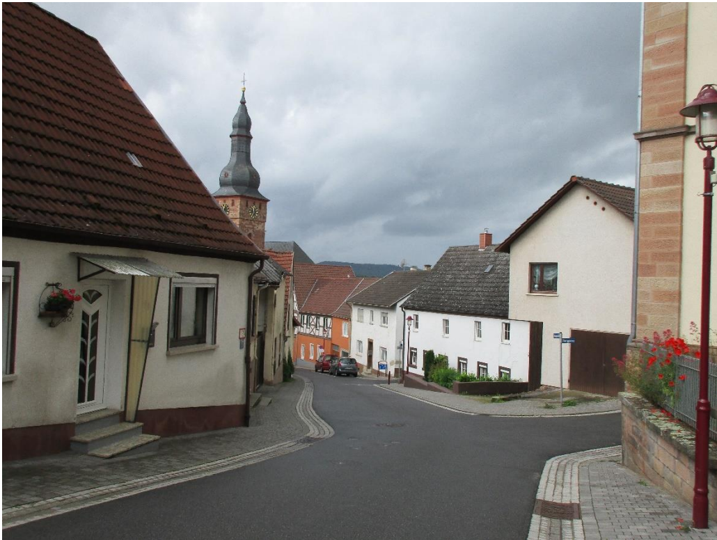
Beispiel für topografiebedingt unterschiedliche Traufhöhen bei (etwa) gleichhohen Gebäuden
